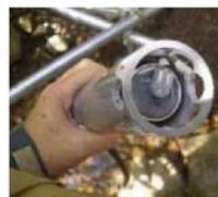
写真3. 濁度計センサー
