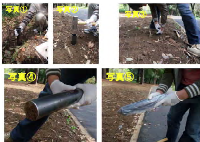
図 26. 鉄パイプ（円筒管）を用いた土壌コア試料の採取方法
