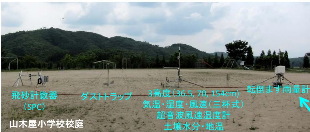
AWSによる摩擦速度、HVによる大気エアロゾル連続測定
