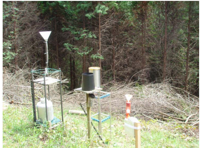
左： サンプラーも設置した状態の遮断プロット 右： 林外雨露場に新設した降水サンプラー(最右端の物)
