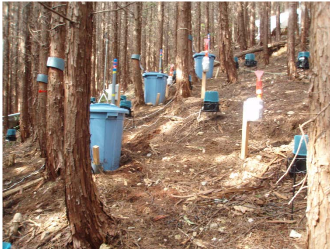
左： サンプラーも設置した状態の遮断プロット 右： 林外雨露場に新設した降水サンプラー(最右端の物)
