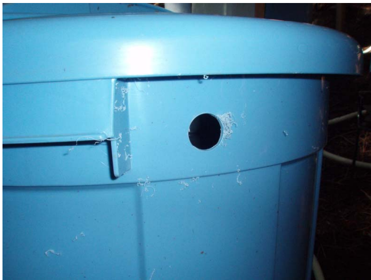
樹幹流ポリバケツへのホース導入. ドリルで穴を開けて(左), ジョイント付きでホースを導入(右)
