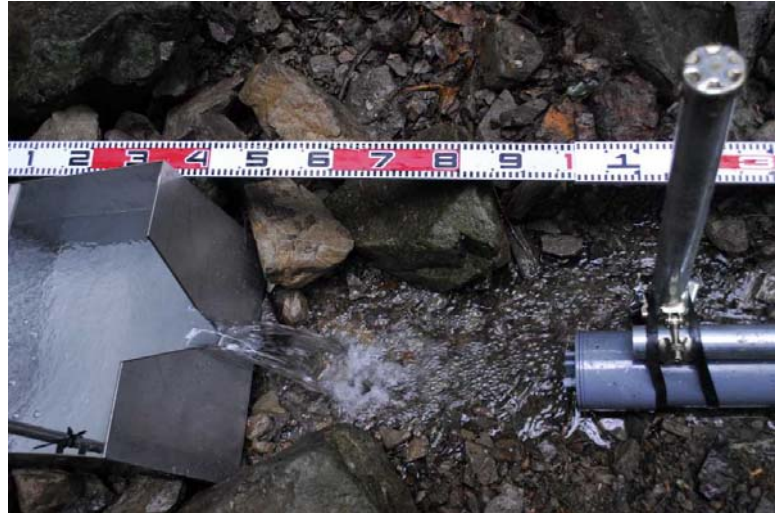
写真15 K6流域のSSサンプラーの様子
