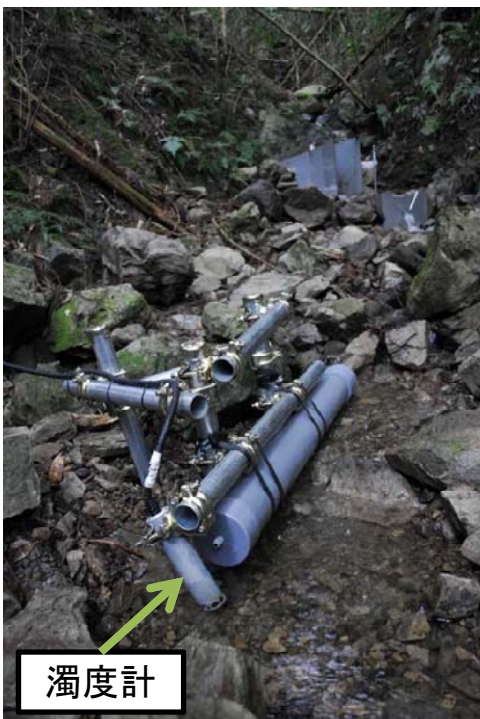
写真7 Y2流域の濁度計設置の様子
