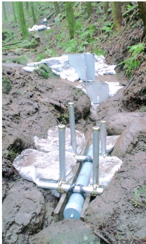
写真2 最上流地点の5inchパーシャルと45度三角堰, SSサンプラー
