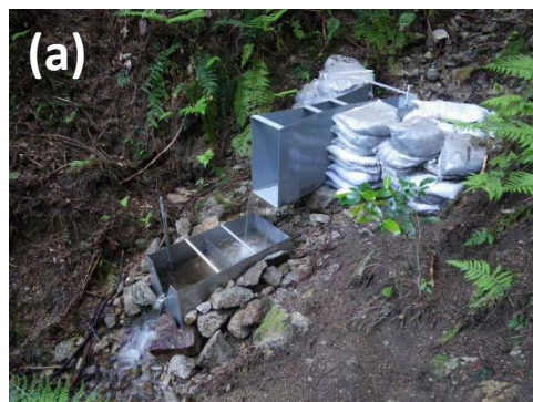
(a)流域中流の量水堰(三角堰満砂) (b)最下流部の量水堰 * 三角堰の土砂をすべて除去した
