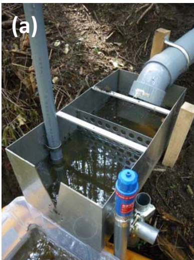
写真3 表面流プロットの 水・土砂流出状況
