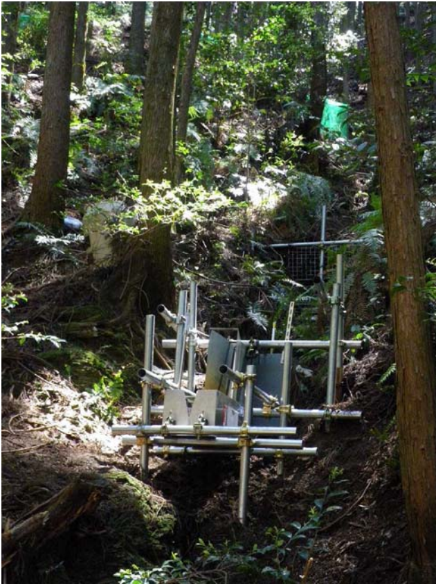
写真24 M4流域の量水堰
