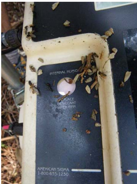
写真30 乾燥剤が取り替え時期(M5流域)
