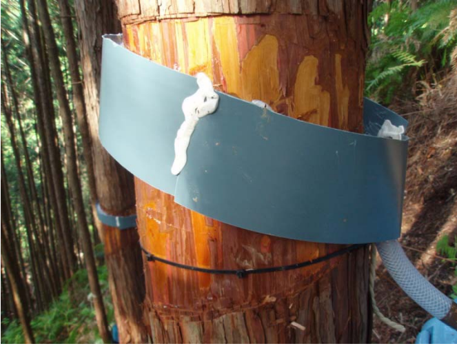
左： 剥ぎすぎた樹皮の様子(樹幹流B) 右： ホースを延長して接続(樹幹流A)
