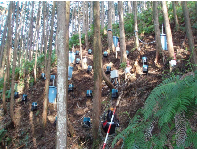
左： サンプラーも設置した状態の遮断プロット 右： 林外雨露場に新設した降水サンプラー
