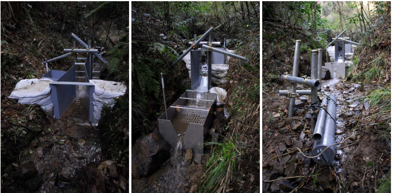
写真5 K2-4流域(井戸設置流域)の機材設置状況 (左から, パーシャルフリーム上流の堰き止めの概観, 三角堰 の設置状況, SSサンプラーの設置状況)
