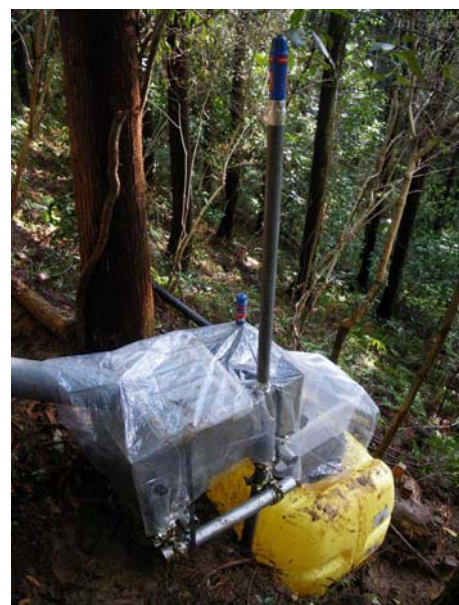
写真5 三角堰・貯水タンク・土砂箱の設置状況(2)
