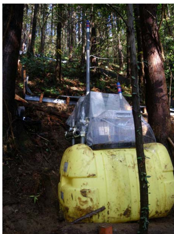
写真4 三角堰・貯水タンク・土砂箱の設置状況(1)
