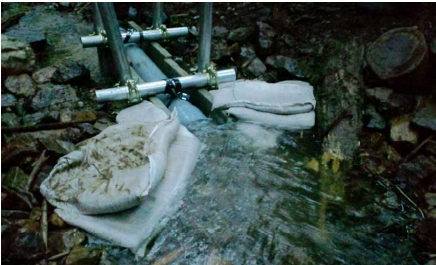
写真3 K2-1地点 SSサンプラー改修後
