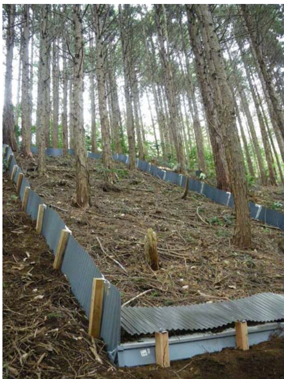
写真1 K2流域荒廃ヒノキ林に設置した表面流プロットの概観
