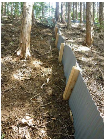
写真8 プロット壁の固定方法
