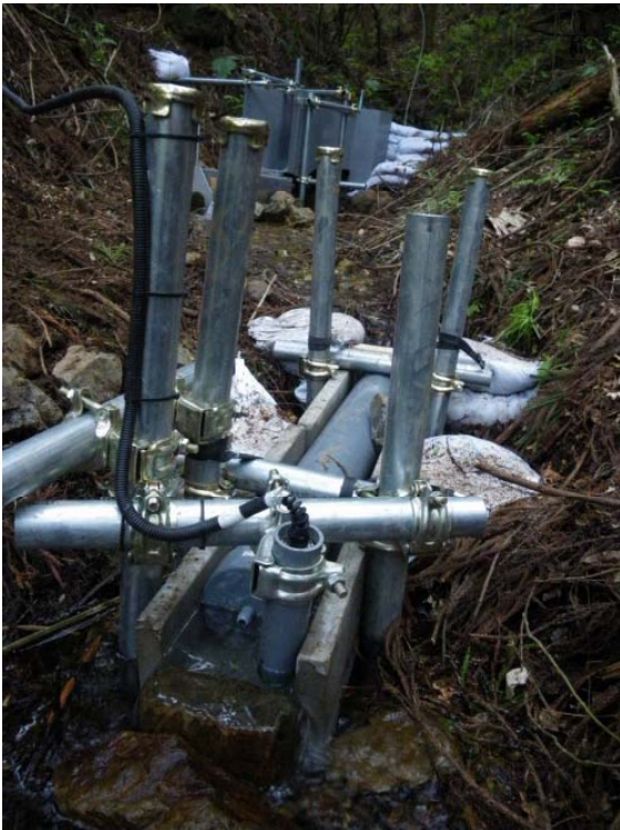
写真13 K3-1流域の濁度観測システム
