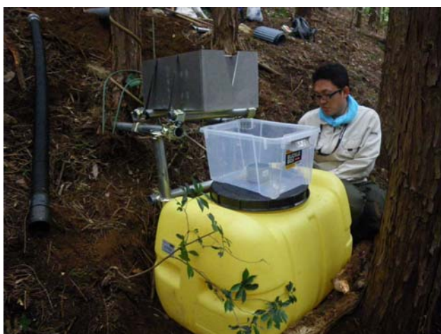
写真3 三角堰と貯水タンクの設置状況(仮設置)
