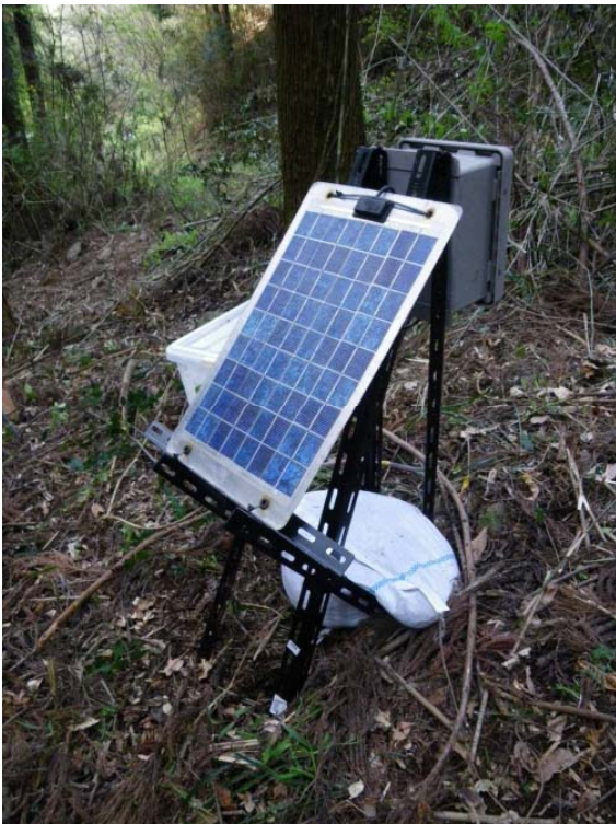
写真15 濁度計のロガー部分と、バッテリー充電のためのソーラーパネル
