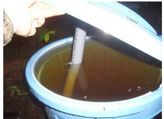
写真13 樹幹流タンク状況
