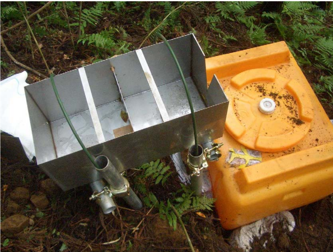
写真5 三角堰・貯水タンクの設置状況
