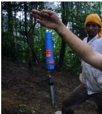
写真12 EC計の取り付け方法
