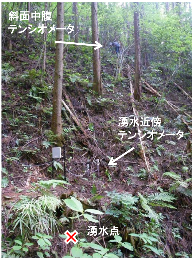
写真1 K2-4流域 湧水点近傍と斜面中腹のテンシオメータ埋設地点
