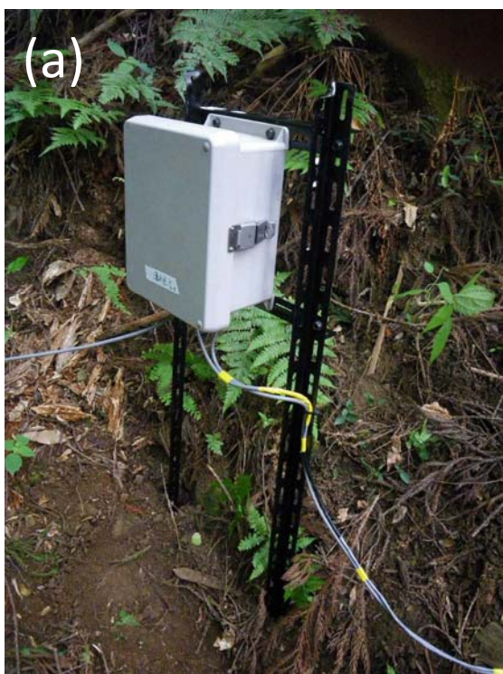
写真2 (a)テンシオメータ用ロガーボックス、(b)ソーラーパネル
