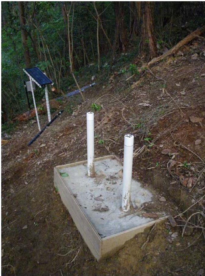
写真3 K2-4流域 井戸近傍のテンシオメータ埋設地点
