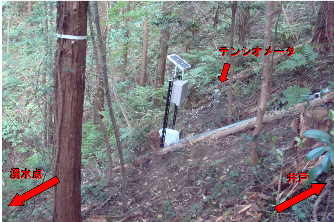
写真 2 斜面中腹のテンシオメータ
