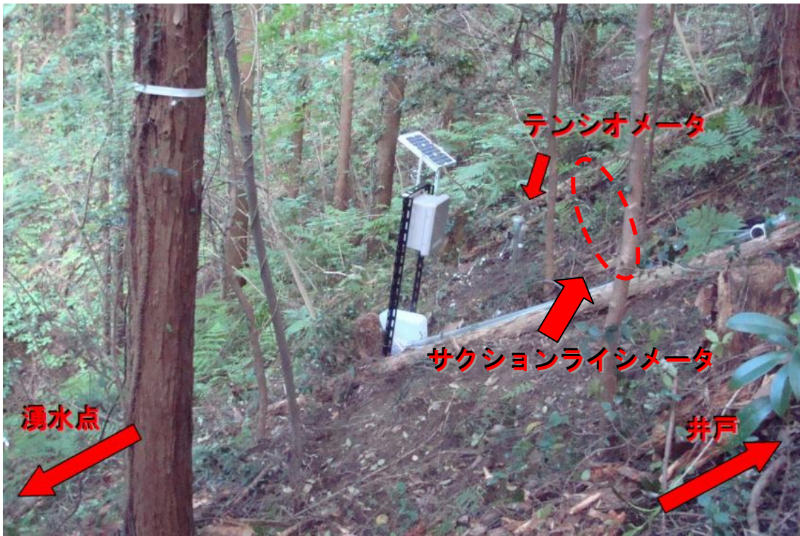
写真 2 斜面中腹のサクションライシメータ設置位置
