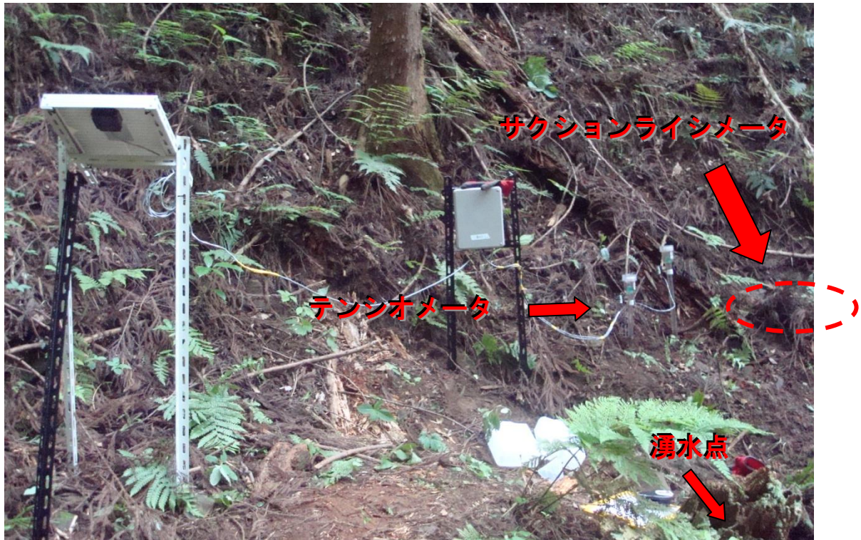
写真 1 湧水点付近のサクシヨンライシメータ設置位置
