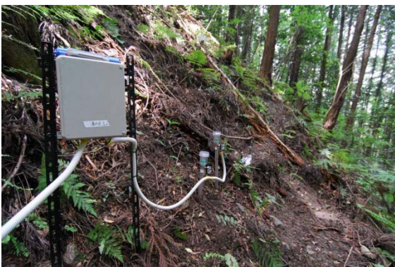
写真3 湧水近傍のテンシオメータ
