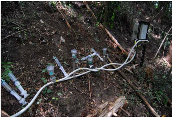
写真2 斜面中腹のテンシオメータ
