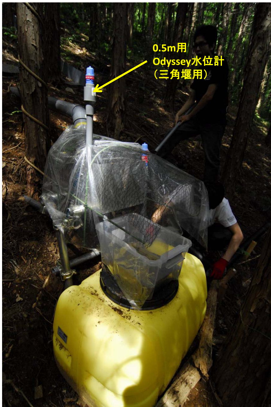
写真8 表面流プロットの量水システム(水位計交換)
