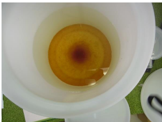
図 8：一晩静置後の Fe 沈殿
