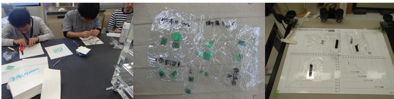
写真. 細片化作業の様子 (左)、細片化したサンプル (中)、カーボンテープに付着させたサンプル (右)
