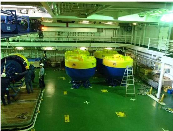
むつ時代の動力用原子炉が設置されていた場所，船の中心部。現在は原子炉は取り外されて，トライトンブイなどの観測機材の収容スペースとして使用されている。
