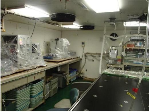
生物・化学実験室 机には揺れに備えて試料等を固定する鉤がある，装置として栄養塩分析装置などがある。\*みらいには造水装置が搭載されており，化学実験用・生活水の制約はほぼない。
