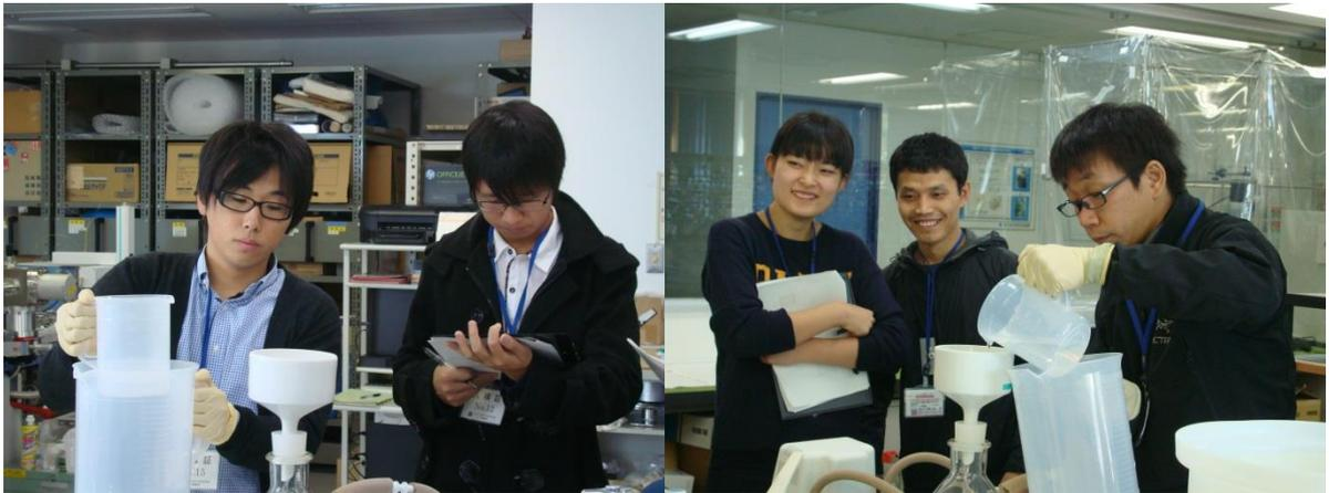
⑥このとき、上澄み液の一部 (50ml) を採取して残留 Cs 測定 (回収率測定) 試料とする。
