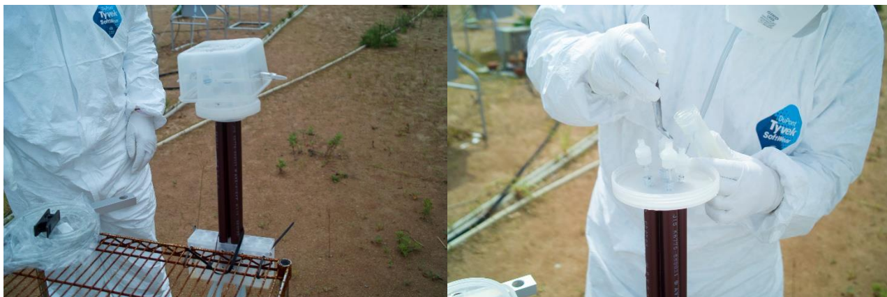
写真3: バイオエアロゾル捕集装置の外観(左)と採取用カラム回収の様子(右)
