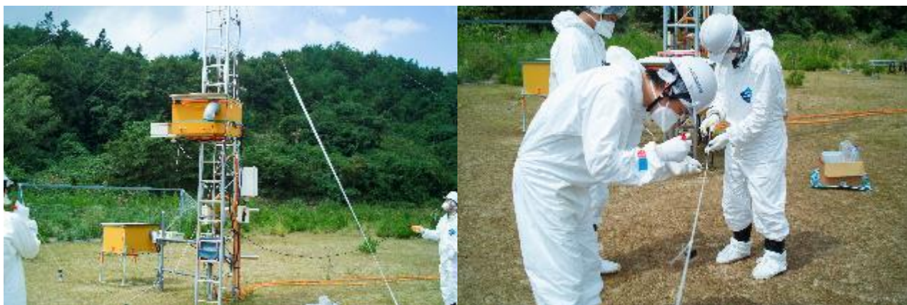
写真4: 高さ別の大気浮遊粒子の採取の様子
