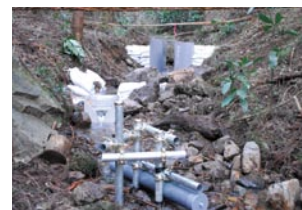
森林流域からの放射性セシウムの流出モニタリング (左写真：パーシャルフリュウム量水堰と自動採水器、右写真：奥からパーシャルフリュウム量水堰、三角堰、浮遊砂サンプラー)
