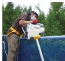
森林観測タワーでの放射能の現地測定 (可搬型ゲルマニウム半導体ガンマ線検出器) Field observation of radioactivity using a forest observation tower (portable-germanium semi-conductor gamma ray detector)
