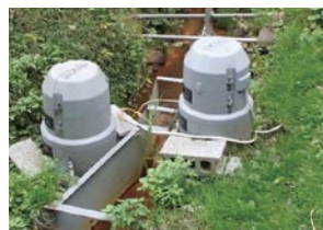
森林流域からの放射性セシウムの流出モニタリング (左写真：パーシャルフリュウム量水堰と自動採水器、右写真：奥からパーシャルフリュウム量水堰、三角堰、浮遊砂サンプラー)
