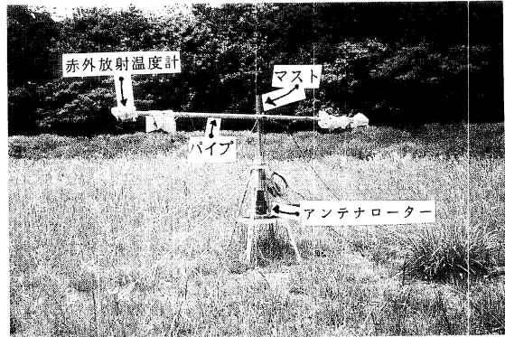
写真1 放射温度計の設置状況
