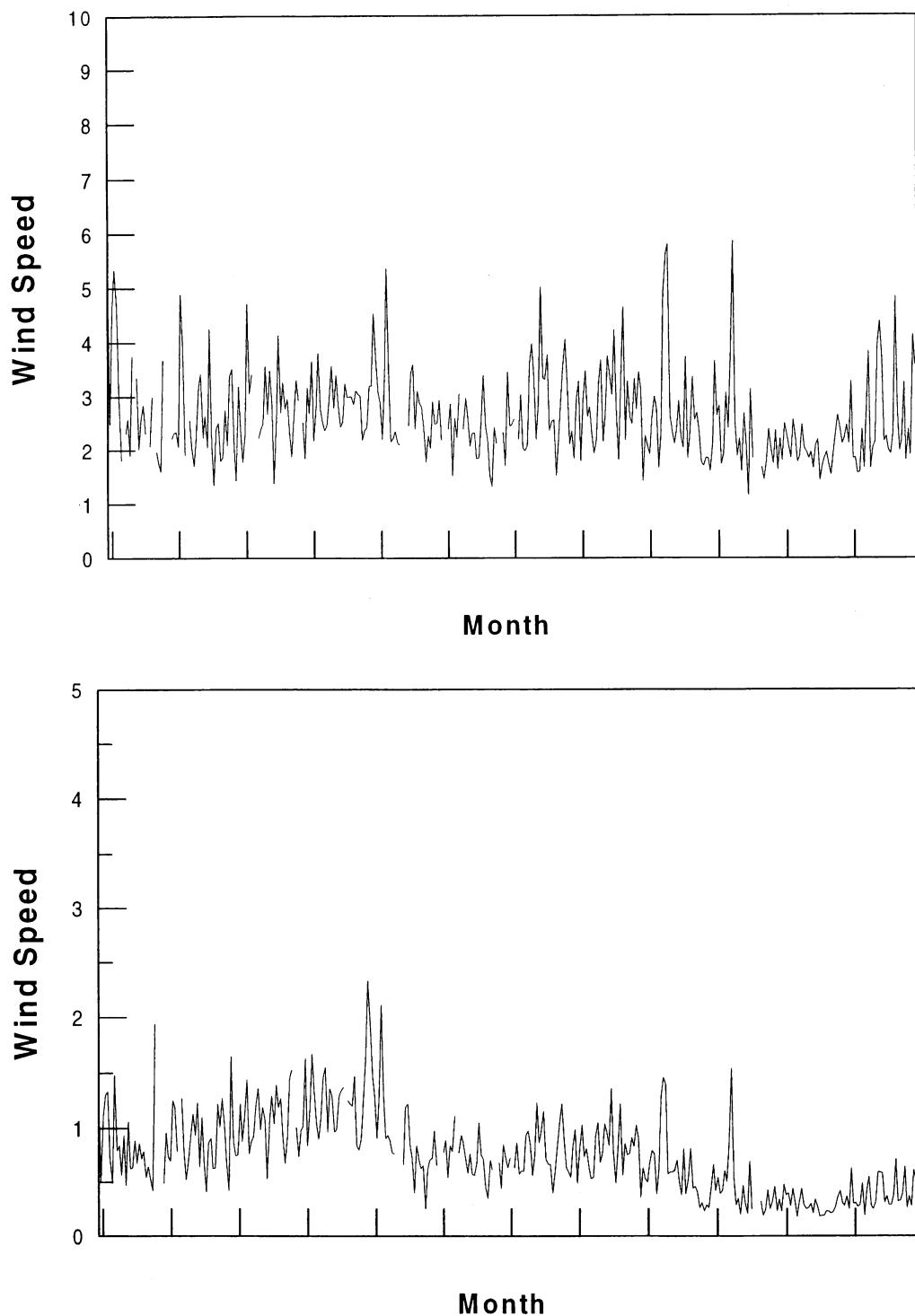
第1図 検定高度 29.5m（上図）、および 1.6m（下図）における風速の日平均値の季節変化
