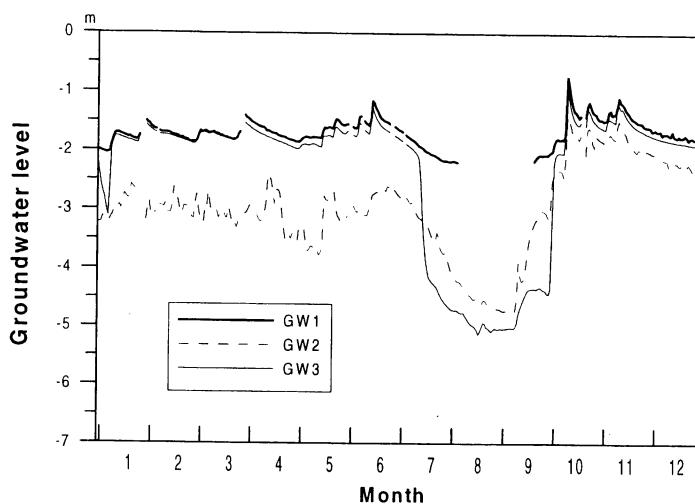
第6図 3深度の観測井 2.2, 10, 22m（上図）における地下水位の日平均値の季節変化
