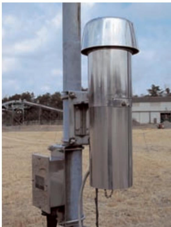
塩化リチウム露点温度計
