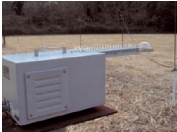
通風型熱電対式放射収支計
