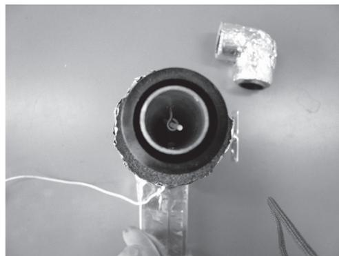
第 2 図 二重通風管の断面
