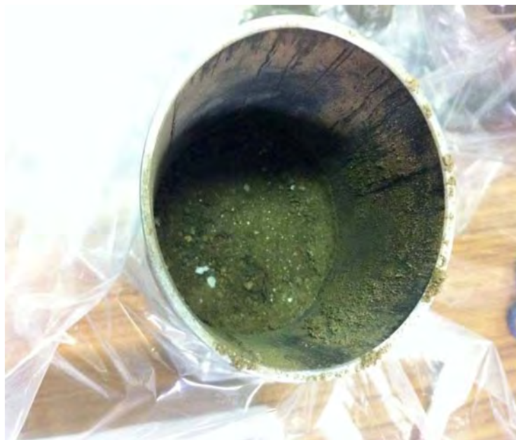
図 4-20 円筒管内で土壌の表面が崩れた土壌コア試料
