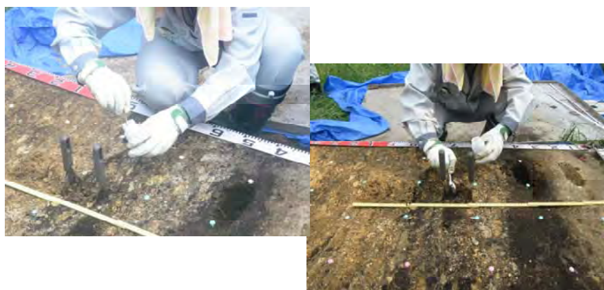
(c) 収着及び Ge 半導体検出器による分析試料の採取
