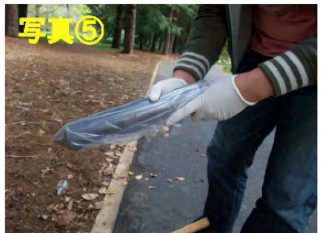
図 4-13 土壌コアサンプルの採取方法
