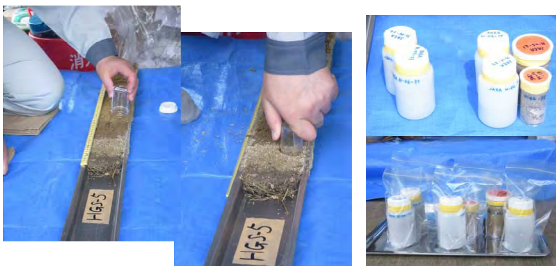
(b) 土質試験試料の採取 (U字型容器) (左側写真) と採取試料例 (右側写真)
