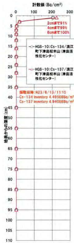
図 4-5 (a) 地表面土壌の深さ方向における放射性物質の濃度分布 (WGS-1, HGS-1, 3, 4, 8, 10)
