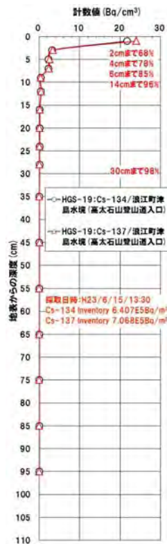
図 4-6(a) 元農地と推定される土壌の深さ方向における放射性物質の濃度分布
