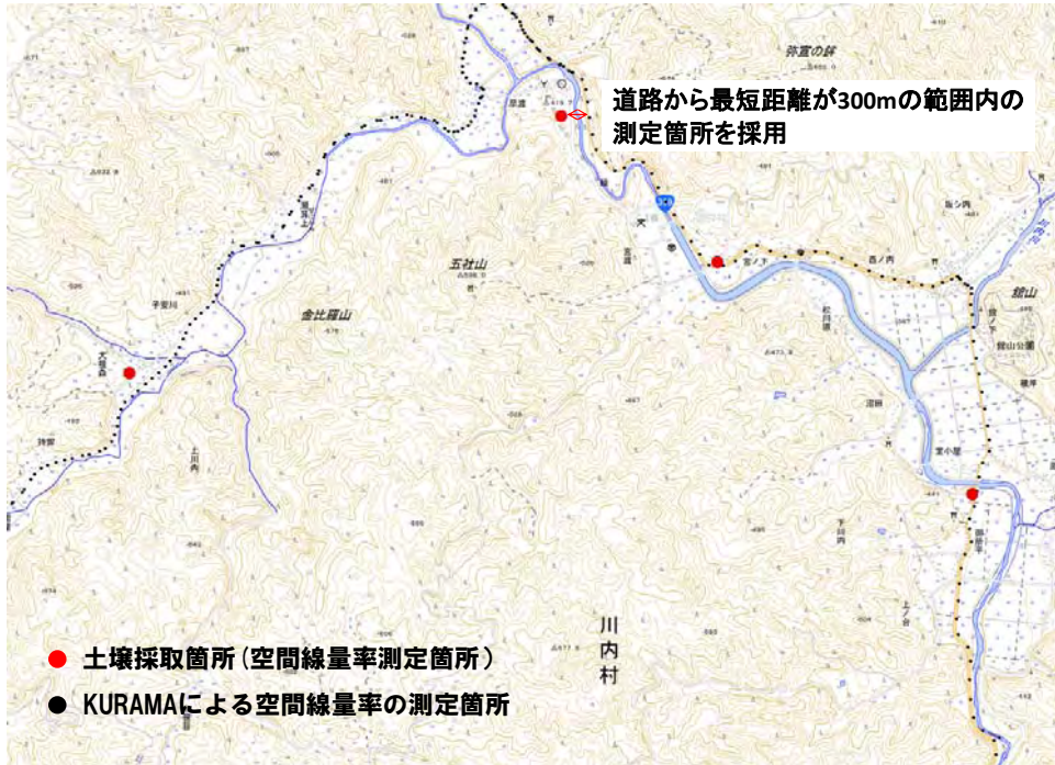
(a) 走行サーベイによる空間線量率の測定結果を比較する土壌採取箇所の条件
