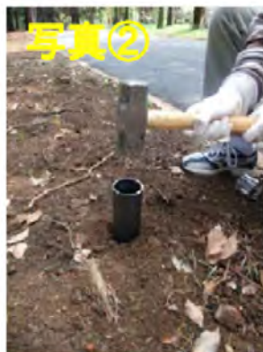
図 4-12 土壌採取に使用された鉄パイプ（円筒管）と両端のプラスチックキャップ
