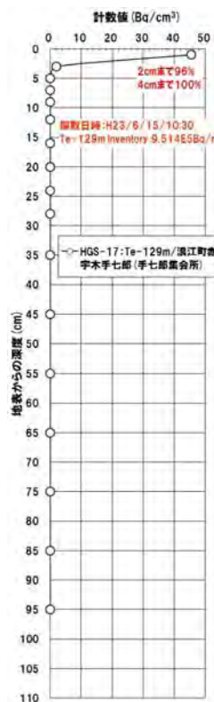
図 4-5 (b) 地表面土壌の深さ方向における放射性物質の濃度分布 (HGS-11, 12, 17, 22)
