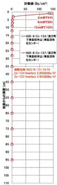
図 4-5 (a) 地表面土壌の深さ方向における放射性物質の濃度分布 (WGS-1, HGS-1, 3, 4, 8, 10)
