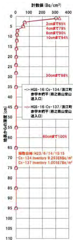
図 4-6(a) 元農地と推定される土壌の深さ方向における放射性物質の濃度分布
