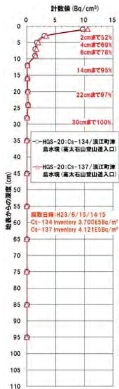
図 4-6(a) 元農地と推定される土壌の深さ方向における放射性物質の濃度分布
