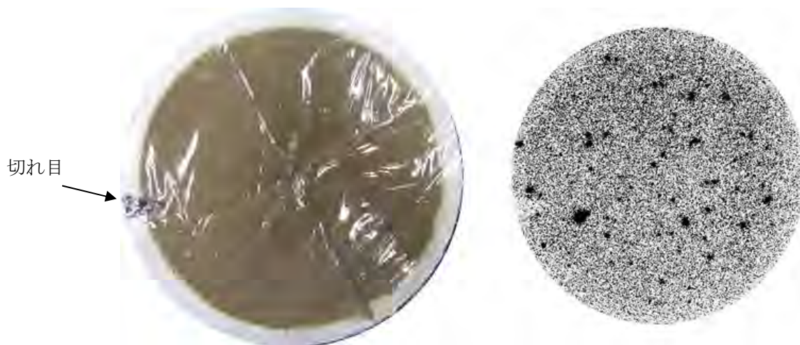
図 6-45 口太川下流の河川懸濁物試料をろ過したフィルタ (直径 14.2 cm) 上の 放射性セシウムの分布状態と光学写真像 (露光時間は 24 時間)
