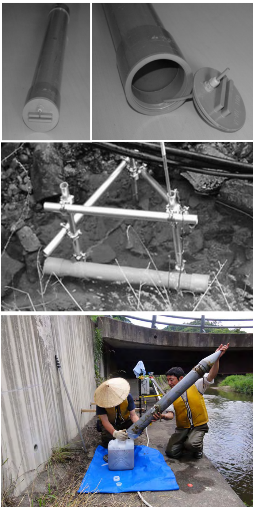
図 5-2 浮遊土砂サンプラーの採取口の構造（上）、河床に設置したサンプラー（中）、浮遊土砂の回収状況（下）
