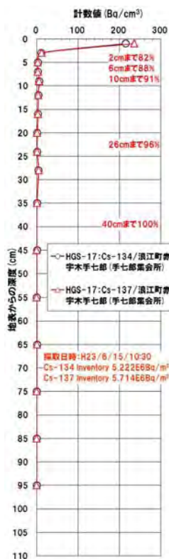
図 4-5 (b) 地表面土壌の深さ方向における放射性物質の濃度分布 (HGS-11, 12, 17, 22)
