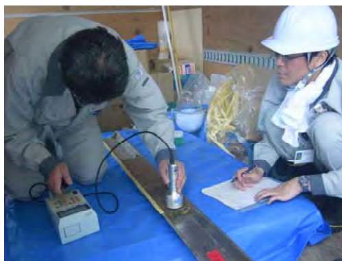
(a) GM サーベイメータによる \beta \cdot \gamma 線計数率分布測定
