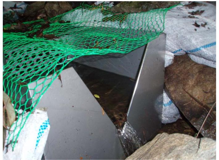
K9流量観測の三角堰. 上流から石が落下していたため, 取り除いた(14:30). 左が取り除く前, 右が取り除いた後.
