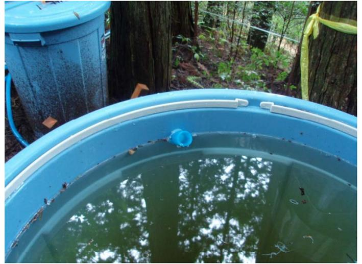
樹幹流ポリバケツ. オーバーフローしないようにバケツ上部にホースを前回取り付けた. うまく機能していたようである.
