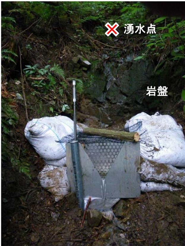
写真1 K2-4流域 湧水点三角堰の設置場所
