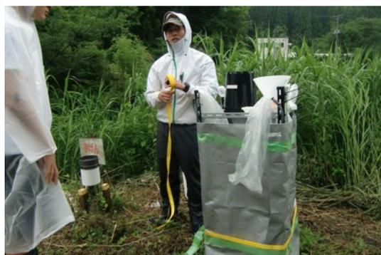
図 3.2.2 河川横に設置された採水器
