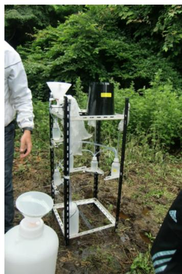
図 3.1.1 雨水分割採取器
