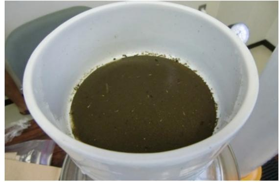
図 2.4.2 流出初期のろ過後のフィルター 図 2.4.3 流出最後のろ過フィルター
