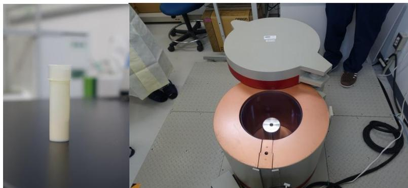
写真3 テフロンチューブに入れた AMP・Cs 化合物 (左)、検出器 (右)
