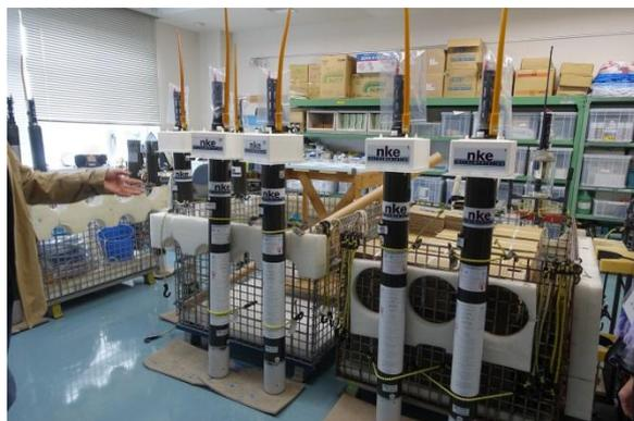
写真5 海洋で漂流しながら表層と水深 2000 m までの水温・塩分を測定するアルゴフロート
