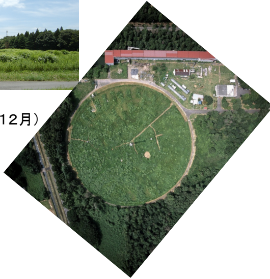
半径約90mの円形圃場 中心に約30mのタワー
