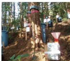
森林内の観測機器 (林内雨・樹幹流採取装置)
