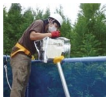
森林観測タワーでの放射能の現地測定 (可搬型ゲルマニウム半導体ガンマ線検出器)
