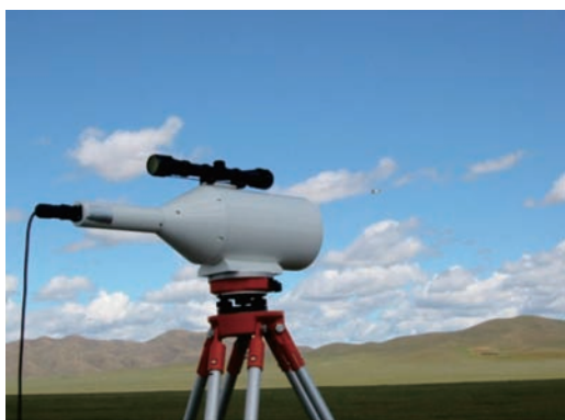
モンゴル半乾燥草原における大口径シンクロ メータによる顕熱フラックスの広域観測. (2003年8月22日)
